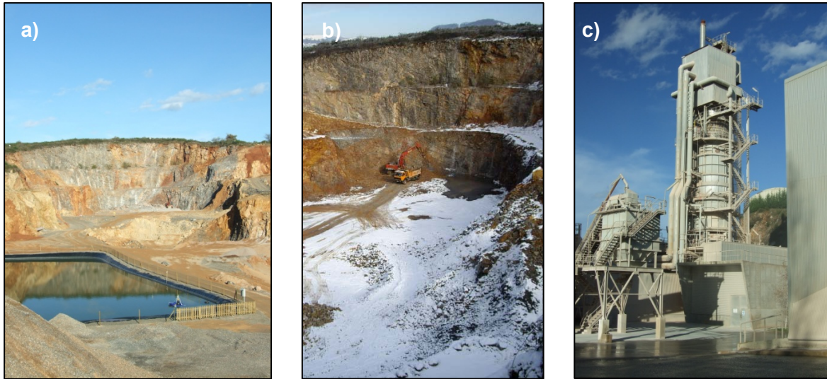
Fig. 3.8.5: “Mina Paula” (o “Caleras Asturianas”, n.º 397). a) Frente principal y balsa de recogida de aguas. b) Labores de extracción de dolomías, en tonalidad ocre, y calizas. c) Horno de calcinación para la fabricación de cal dolomítica.
