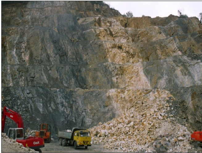
Fig. 3.5.4: Tramo superior de la Caliza de Vegadeo, con niveles de mármoles y calizas marmóreas, en la explotación “Reguero de los Prados” (n.º 69).
