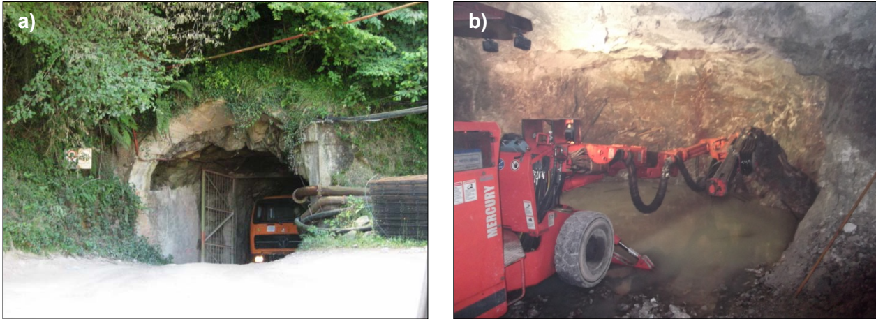
Fig. 3.9.3: a) Bocamina de "Mina Emilio" con sección suficiente para la entrada de camiones de tres ejes. b) Labores de perforación mediante jumbo en uno de los frentes de explotación de "Mina Moscona".
