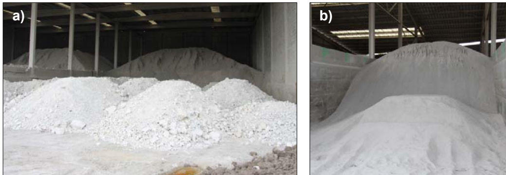
Fig. 4.2.9: a) Acopio de caolín de la explotación “Nueva Perdiz”. b) Acopio de material 0/3
