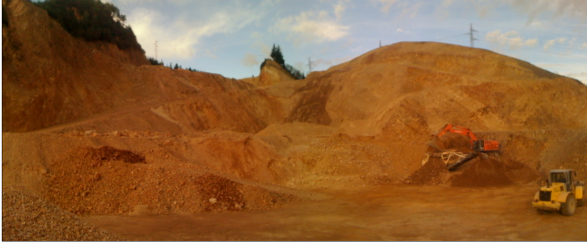
Fig. 3.3.8: Labores de extracción y acopio de material en el frente S de la cantera “La Llamazona” (n.º 725).
