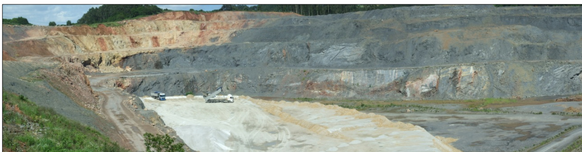
Fig. 3.11.4: Explotación “El Percil”: a la izquierda y al fondo, en tonos beige, calizas dolomíticas de la Fm. Barcaliente; en tonos oscuros, en el centro y derecha, materiales pizarrosos del Mb. Pinos de la Fm. San Emiliano.
