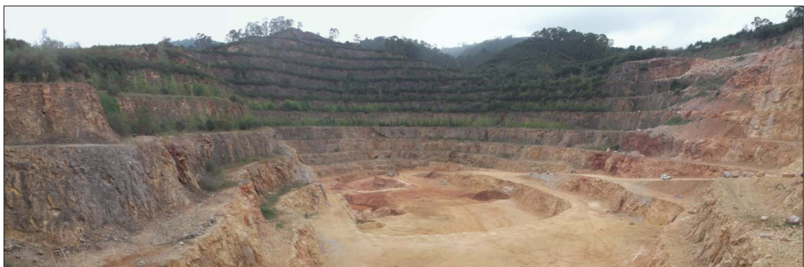
Fig. 3.8.4: Vista general del frente “Cuarteles” de la “Cantera del Naranco” (n.º 451), donde se beneficia dolomía para su utilización como fundente en siderurgia.
