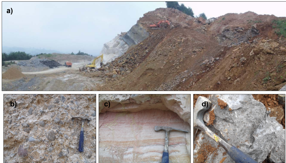
Fig. 2.4.6: Fms. Pola de Siero y Ullaga. a) Frente de cantera de la “La Peñuca” (Est. n.º 602), donde se explotan ambas formaciones. b) Detalle de los conglomerados de la Fm. Pola de Siero. c) Intercalación arenosa en la Fm. Pola de Siero. d) Detalle de la caliza de la Fm. Ullaga.
