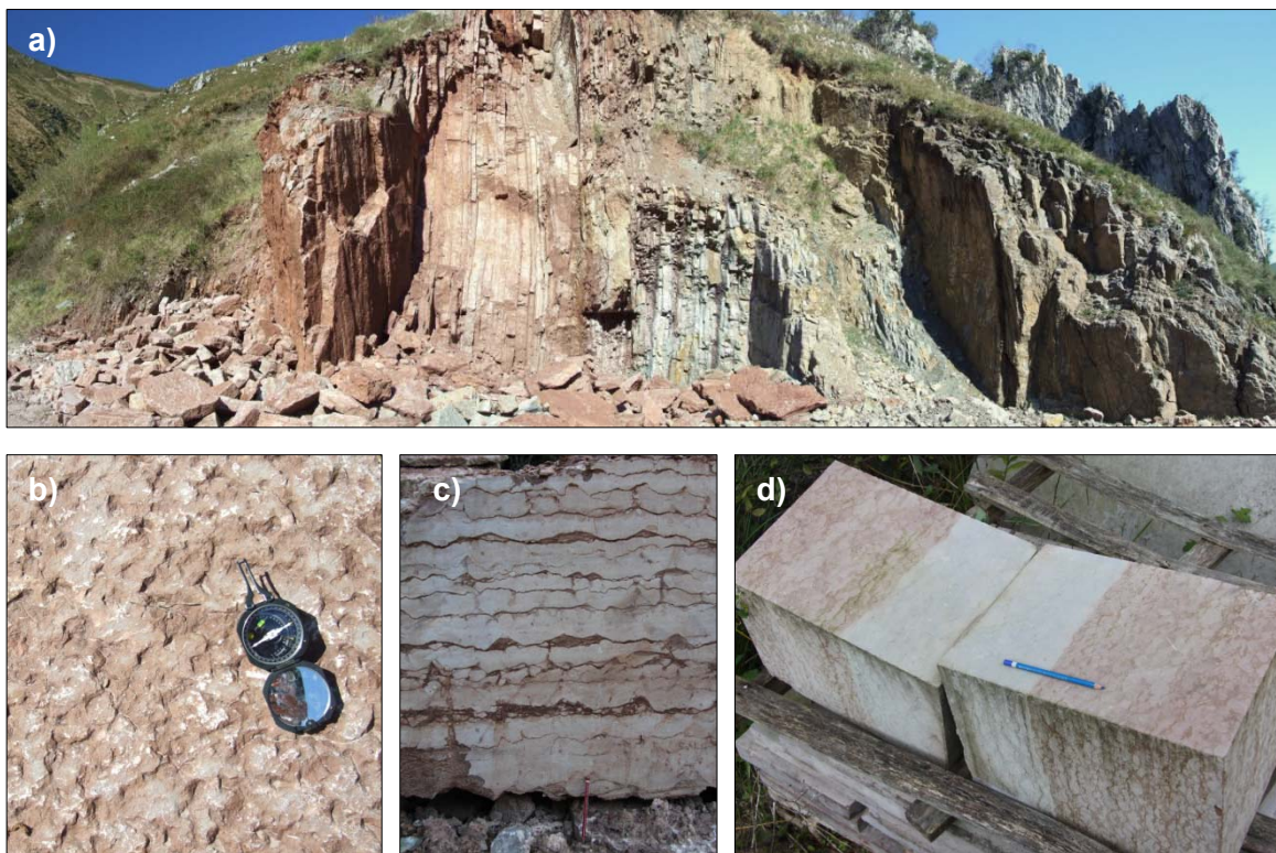
Fig. 2.3.4: Fm. Alba o “caliza griotte”. a) Frente principal de la explotación “Collaín del Río Pasón” con calizas rojas a la izquierda y grises a la derecha. b) Aspecto noduloso de la roca en la cantera “Collaín del Río Pasón.” c) Corte perpendicular de las calizas nodulosas en “La Javariega”. d) Bloques cortados en la planta de Meré con las dos variedades de color de la roca.
