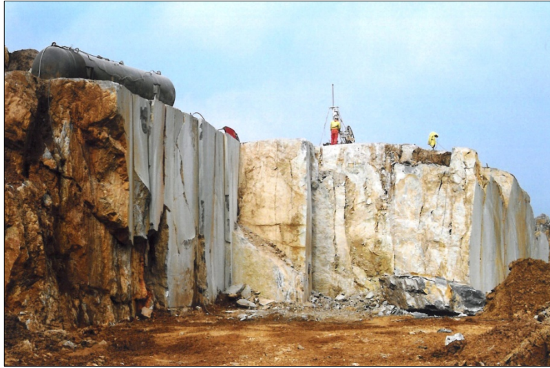
Fig. 3.5.5: Frente de explotación de caliza para roca ornamental en la cantera “San Cosme” (n.º 266).
