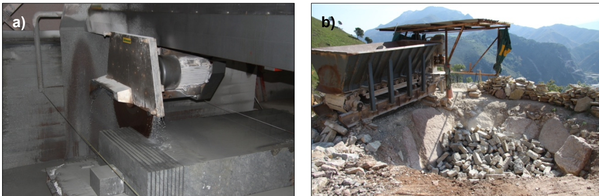
Fig. 4.2.14: a) Corte con disco de un bloque de caliza griotte gris ( Gris Cabrales ). b) Fabricación de bloque artesanal. Cantera “La Javariaga”, Meré.
